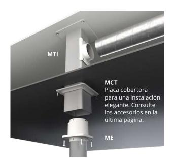
**ATEX (EX):** Piezas de aluminio y metálicas lacadas con una laca especial conductora (negra), conexión de canal de polipropileno conductor. Cable de conexión a tierra para una toma de tierra segura. Cumple la Directiva ATEX 2014/34/UE categoría 2 para gases y polvo.
