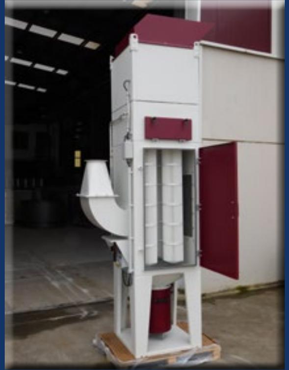
**FILTROS COMPACTOS "ATEX" CON PANELES DE VENTEO Y DIVERSOR DE LLAMA**
