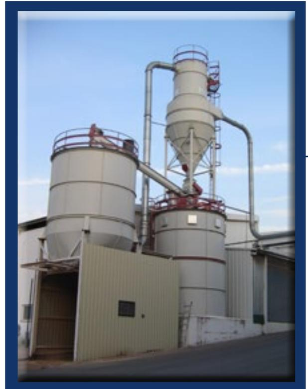
**SILOS DE ALMACENAMIENTO CON TRANSPORTE NEUMÁTICO DE MATERIAL MEDIANTE CICLÓN EN CIRCUITO CERRADO**
