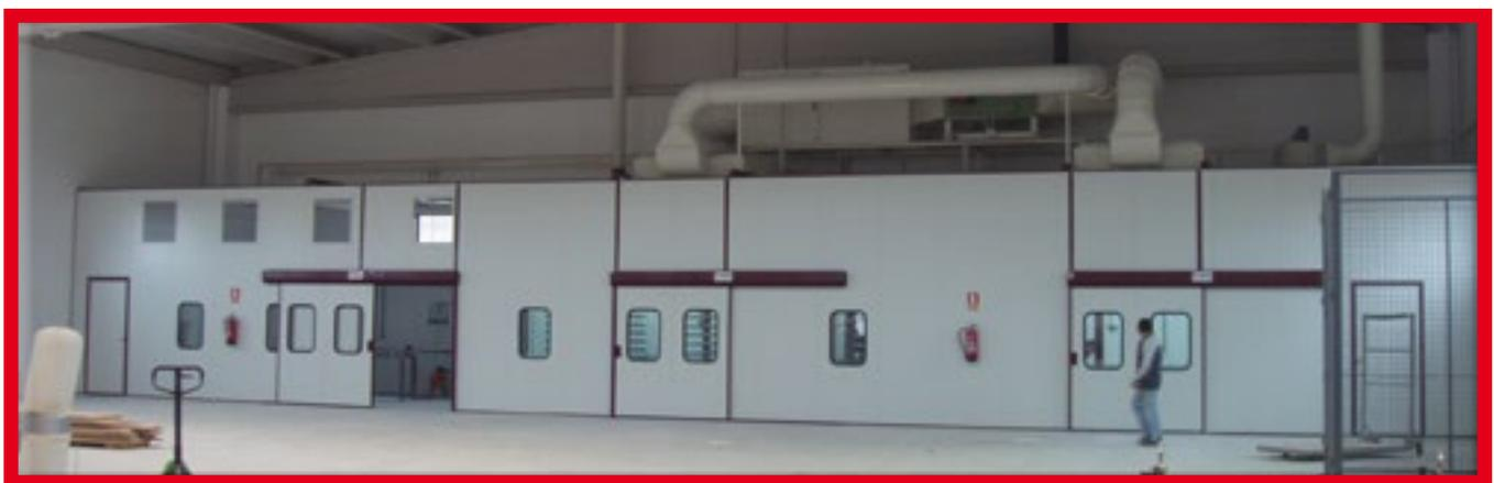
**CABINAS MODELO “FILTROCAB” DE ASPIRACION FRONTAL POR MANGAS FILTRANTES CON LIMPIEZA AUTOMÁTICA POR AIRE COMPRIMIDO Y VARIADOR PARA SELECCIÓN DE CAUDAL DE ASPIRACIÓN Y DE CONSUMO ELÉCTRICO.**
