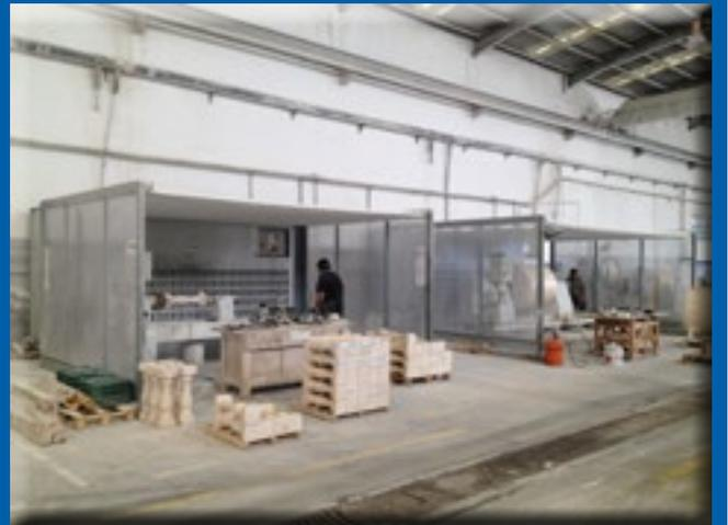
**CABINAS DE ASPIRACIÓN POR CORTINA DE AGUA, MODELO “HIDROCAB”**
