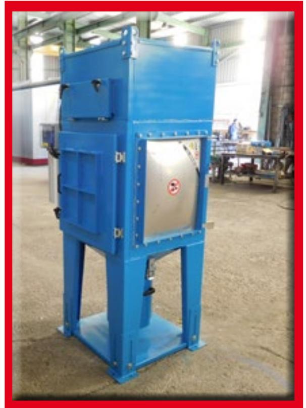
**FILTROS CON LIMPIEZA DE MANGAS POR VIBRACIÓN CON DESCARGA A CONTENEDOR O BIG-BAG**
