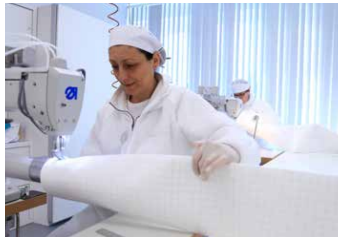
Fabricación de mangas: cabezal/fondo personalizado; costura cosida, soldada o sellada con PTFE.
